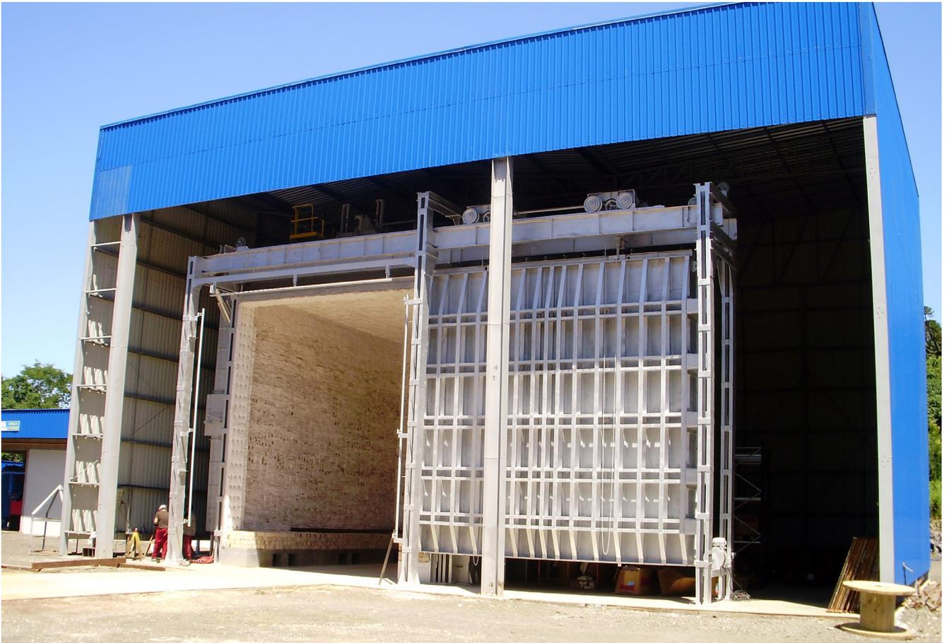
A TECNOTRAT é fabricante de fornos industriais para tratamento térmico de alívio de tensões, recozimento, tempera, solubilização e normalização.
